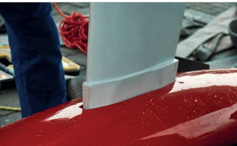
Konzol illesztése a bulbához
