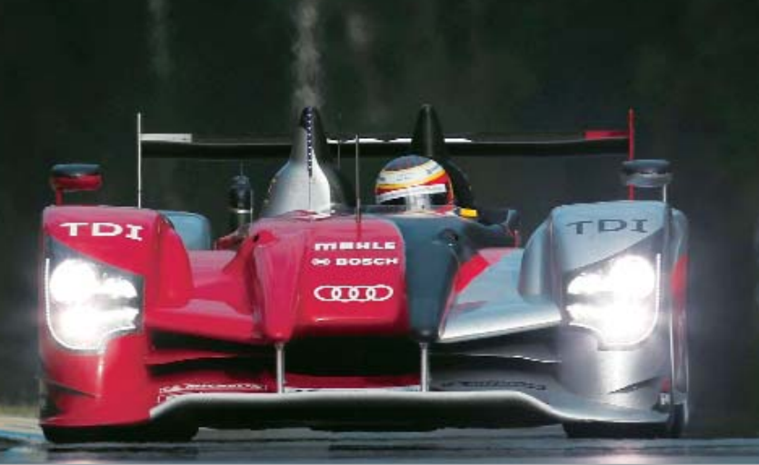
A mai versenyautók vázanyaga és burkolata is karbon-epoxi kompozit
