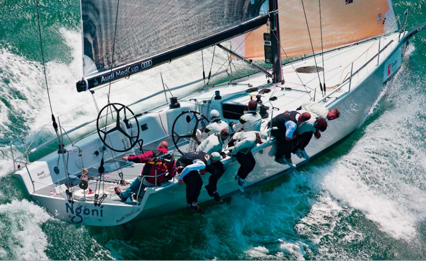
Üveg- és karbon-epoxi kompozitból épül a Soto 40-es – fotó: Stefano Gattini
