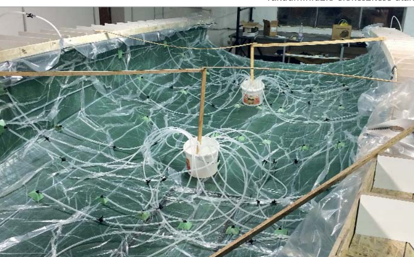
Vákuuminfúzió előkészítése után
